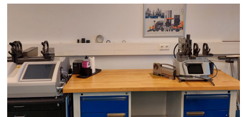
Schulungs-Arbeitsplatz an der SLV Nord mit momentan zwei IR-Schweißmaschinen
