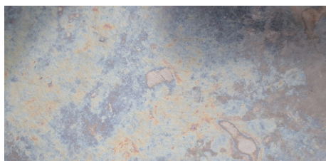
So sollte es nicht aussehen: typische Anlaufarben bei Edelstahl
