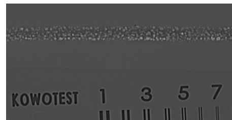
Das Röntgenbild der im handgeführten Laserschweißen entstandenen Naht zeigt zahlreiche kleine Poren
