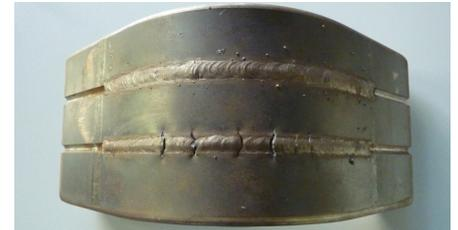
*Aufschweißbiegeversuch mit Schweißpickeln*
