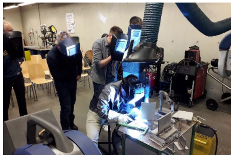
Schweißtechnische Vorführung hochlegierter Fülldrahtelektroden im Vorführraum
